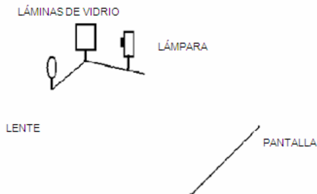
Figura 4 Montaje del banco óptico articulado para la cuña de aire
